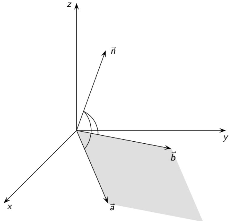
$$\begin{pmatrix} a_1 \\ a_2 \\ a_3 \end{pmatrix} \times \begin{pmatrix} b_1 \\ b_2 \\ b_3 \end{pmatrix} = \begin{pmatrix} \quad \\ \quad \\ \quad \end{pmatrix}$$
